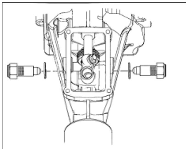
注意：安装时区分左右，左侧的定位机构组件弹力较小（从变速器的输出轴向输入轴看）。
