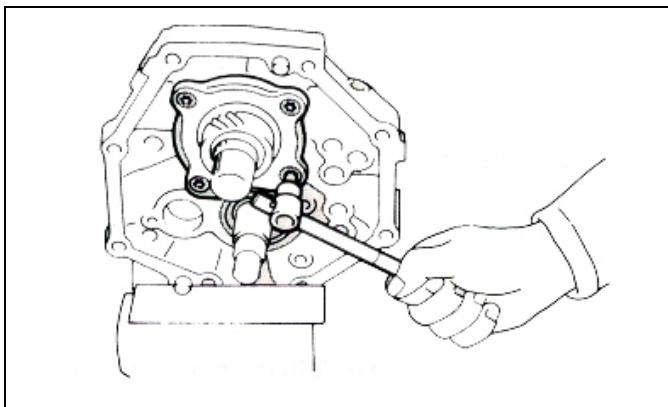
使用转矩套筒扳手安装、拧紧螺钉。
