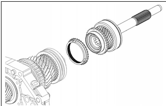
e. 输入轴分总成（轴内滚针不得遗失）、三四档同步器齿环。
