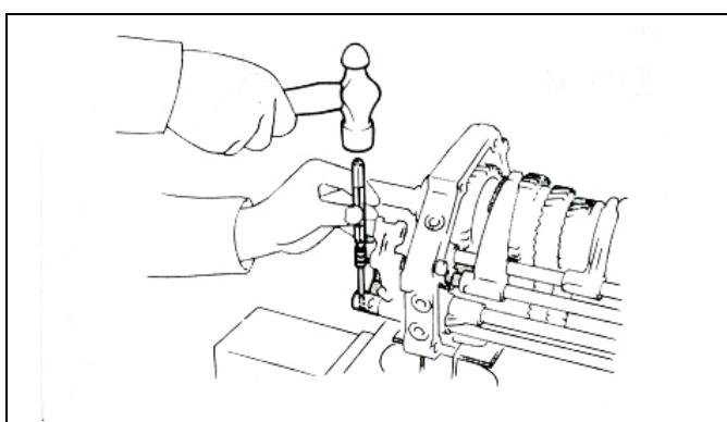
(g) 使用冲头和锤子将弹性圆柱销敲进五档换档叉（弹性圆柱销开口方向朝叉轴轴向）。
