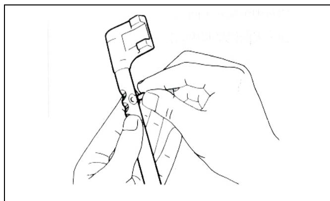
(a) 在互锁导柱上涂上润滑脂，将之安装在一、二档换档叉轴上。
