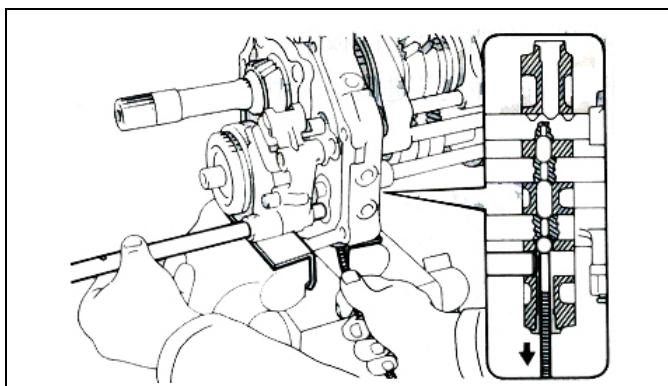
(e) 使用磁棒将互锁钢球装入中联板。
