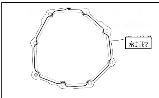
(a) 如图所示在变速器壳体上涂上密封胶（胶线在螺纹孔内侧封闭）。
