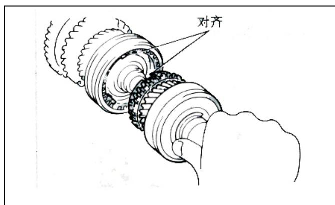
(c) 将输入轴转入输出轴，使同步环三槽对正同步器滑块。
