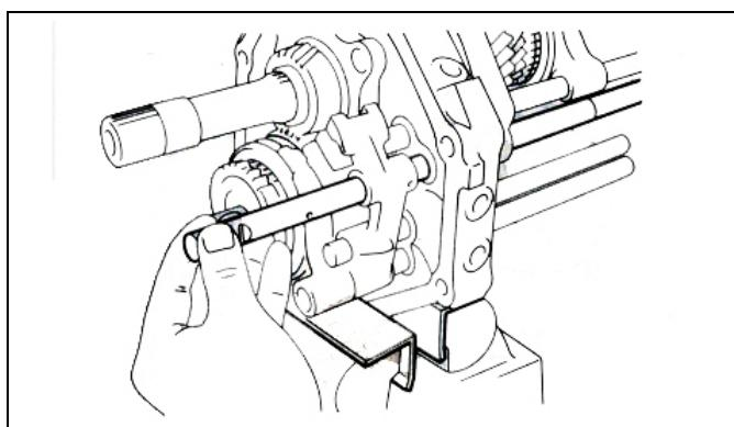
(h) 将五倒档换档叉轴装入五倒档换档导块和中联板。
