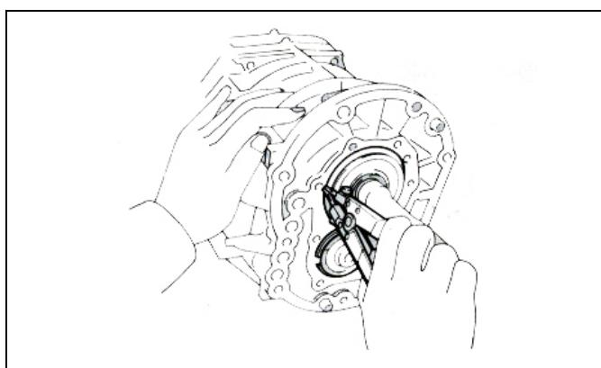
(a) 使用卡环钳将 2 个止动环装在输入轴轴承和中间轴前轴承上。
