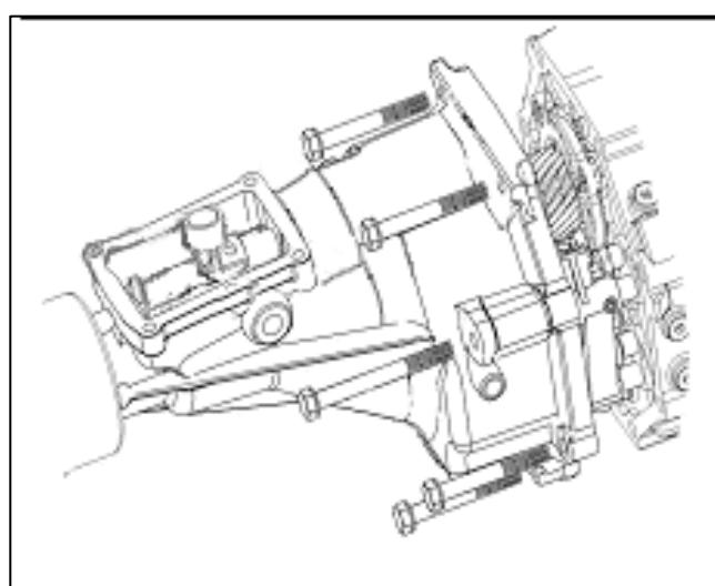
(c) 将装有换档拨杆的换档轴装入后体，不要到位，将变速器挂入三档位置。
