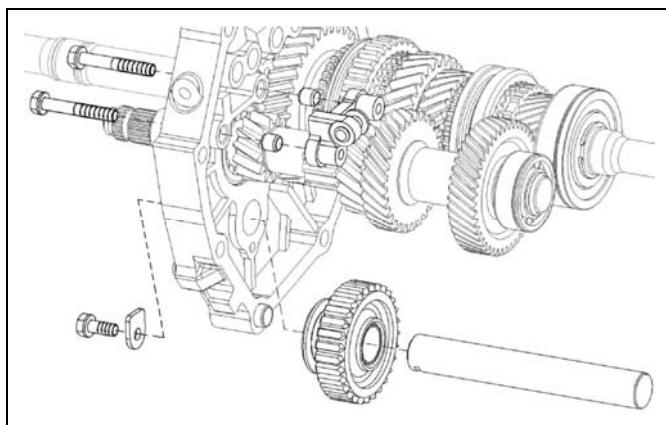
c. 拆下倒档摇臂支架组件、倒档惰轮轴压板、再拆下倒档惰轮组件及倒档惰轮轴。
