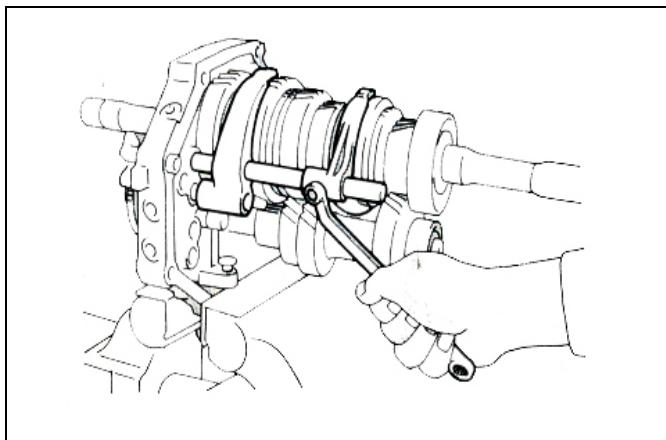
(c) 安装三、四档换档叉固定螺栓，拧紧螺栓。（本产品采用锁销合件联结，锁销开口方向朝叉轴向）
