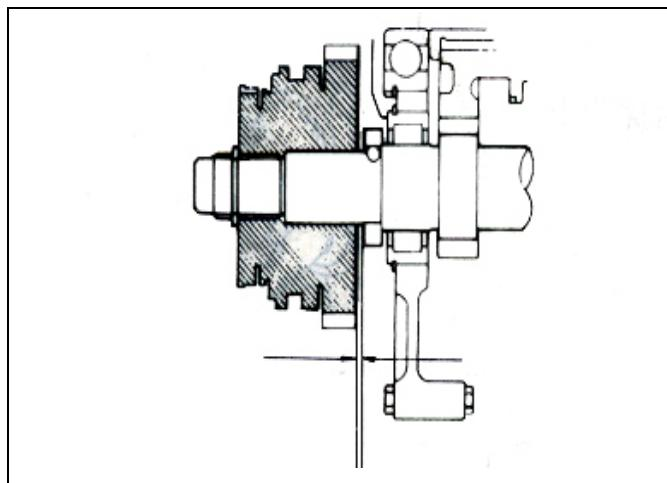
使用塞尺测量中间轴五档齿轮轴向间隙。
