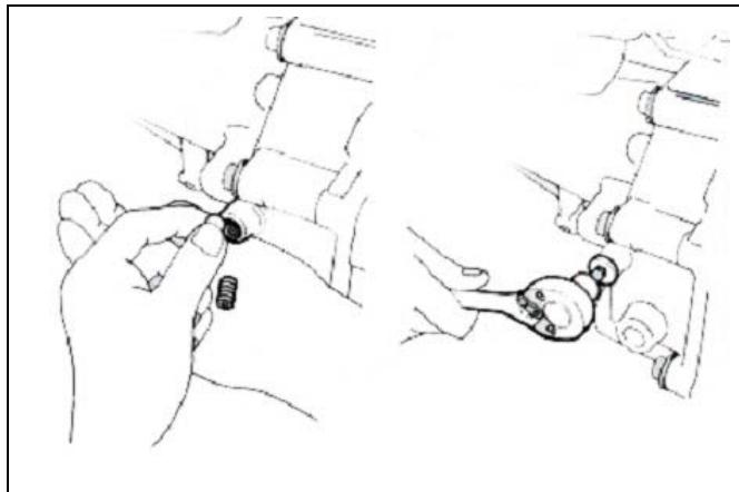
(a) 在螺塞的螺纹上涂上密封剂。
