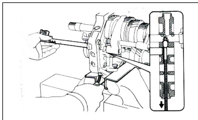
(b) 使用磁棒将短互锁销装入中间板。
