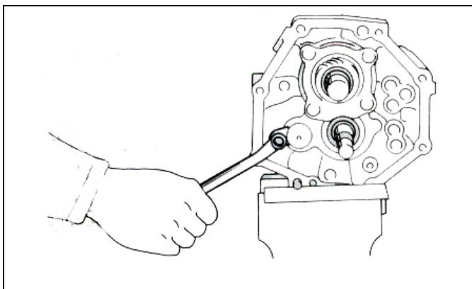
(b) 安装倒档惰轮轴压板，拧紧螺栓。
