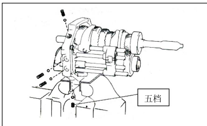
(a) 安装锁球和弹簧（4个锁球和4个弹簧）。
