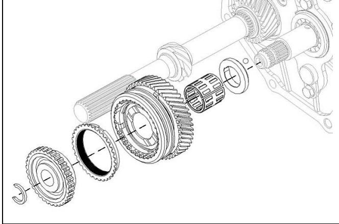
a. 顺序拆下中间轴后轴用挡圈、五档联结齿轮、中间轴五档齿轮分总成；中五档滚针轴承、五档齿轮止推垫圈、钢球( $\Phi 6.35$ )。
