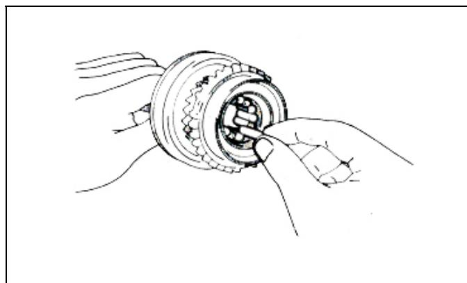
(b) 在 13 个滚针轴承上涂上润滑脂，将滚针装入输入轴，再放上三四五档同步器齿环。
