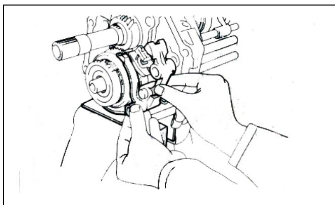
(a) 将五倒档换档导块装入倒档换档叉轴上。
