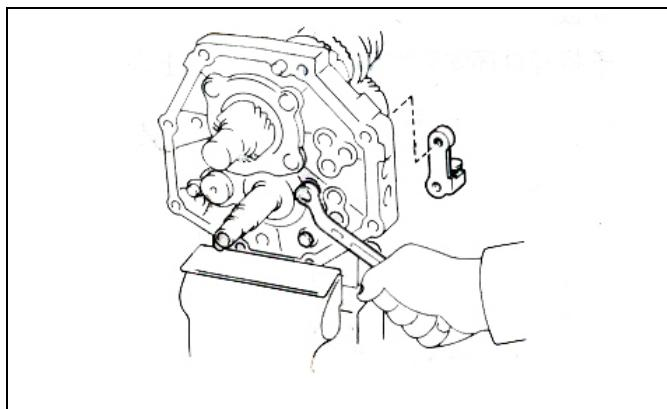
在中联板上放上两个小空心定位销，装上倒档摇臂支架，拧紧 2 个螺栓。
