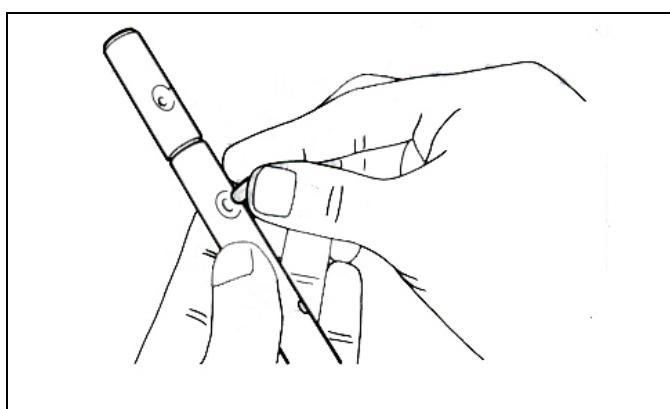
(c) 在互领导柱上涂润滑脂，将之安装倒档换档叉轴上。
