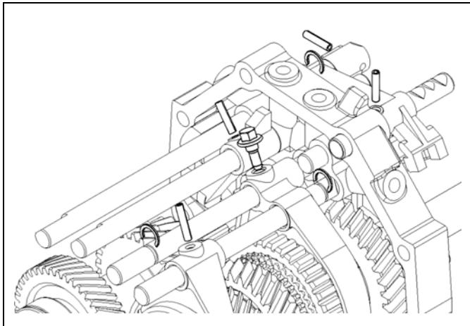
b. 拆去各换档叉锁销合件、弹性圆柱销、一二档换档叉定位螺钉、夹紧挡圈，在拆各换档叉锁销合件和弹性圆柱销时，可用小于Φ5（如Φ4.5）的冲头，将销子从图示的另一侧冲出。
