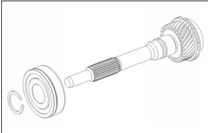
(a) 在输入轴上装上输入轴轴承，使用卡环钳装入输入轴挡圈
