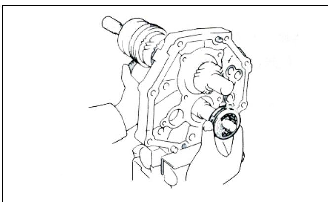
(a) 将止动环安装在中间轴后轴承上。
