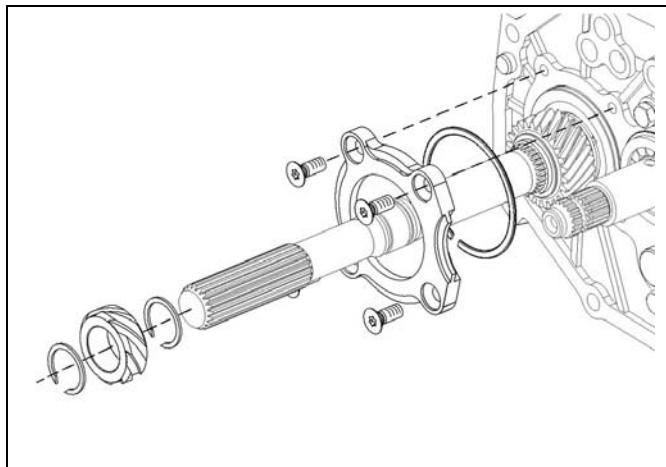
b. 顺序拆下里程表主动齿轮挡圈、里程表主动齿轮、输出轴后轴承挡板、输出轴后轴承止动环。
