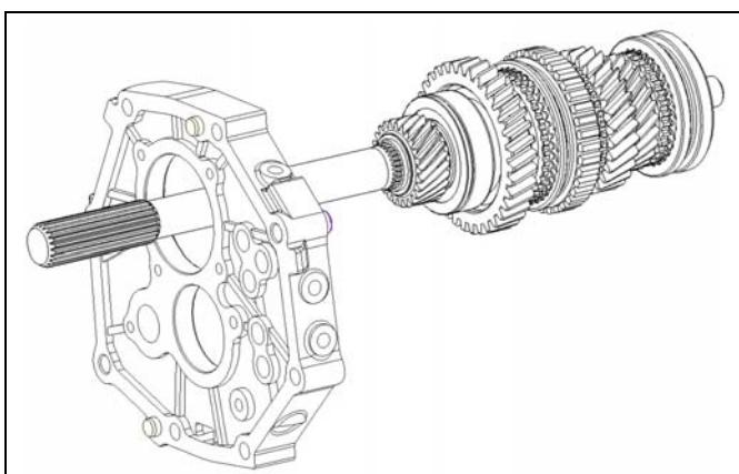
f. 拆下输出轴分总成。
