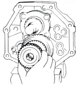
(a) 将同步器齿环套在五档联结齿轮锥面上。
