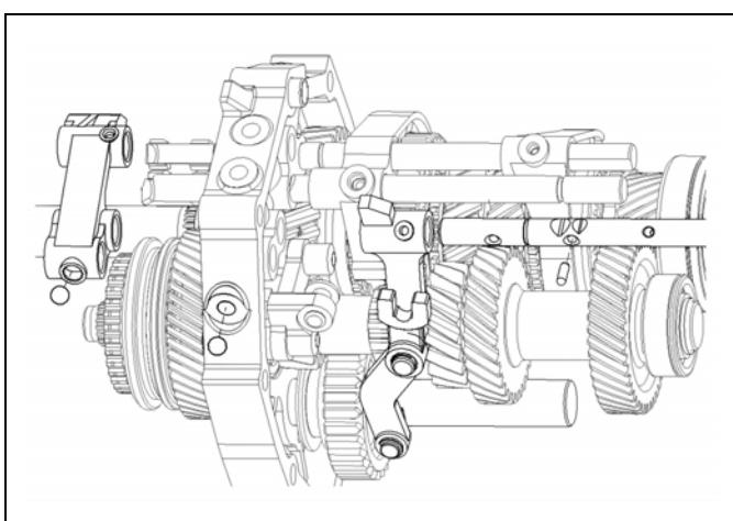
d. 取出五倒档换档导块中的互锁钢球及中联板中的互锁钢球，拆下五倒档换档导块、倒档换档叉轴、倒档换档拨块摇臂合件，拆下倒档换档叉轴后，取出其中的互锁导柱。
