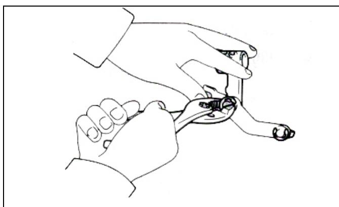
(a) 将倒档拨块、倒档拨杆和 2 个 E 型环装在倒档摇臂上。
