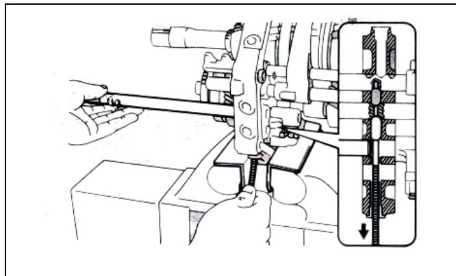
(d) 使用磁棒将互锁销装入中联板。
