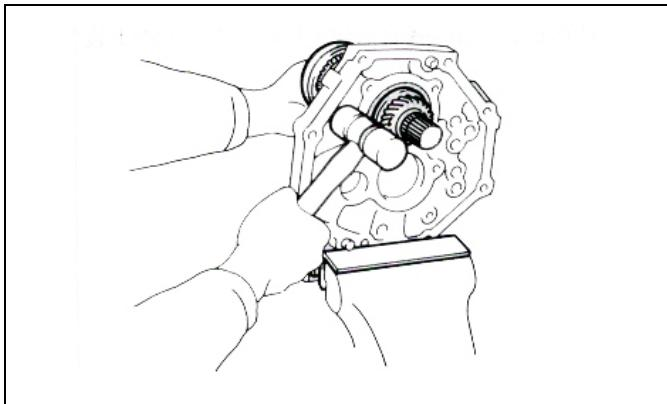
(a) 一边拉输出轴，一边敲进中联板，将输出轴装入中联板。
