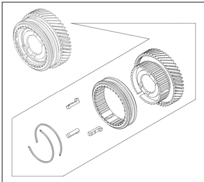
(a) 组装中间轴五档齿轮总成，按图示装配。
