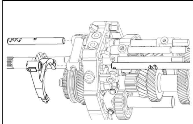
c. 顺序拆下五倒档换档叉轴、五档换档叉轴、五档换档拨叉。
