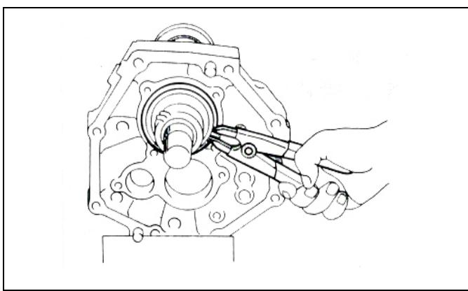
(b) 使用卡环钳装入输出轴后轴承止动环。
