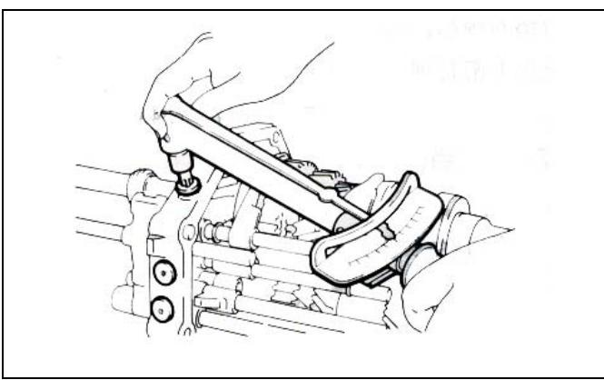
(b) 在螺塞的螺纹上涂上密封剂。
