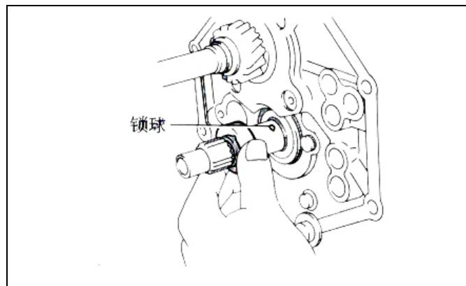
9、安装带有五档啮合套总成和滚针轴承的中间轴五档齿轮。
