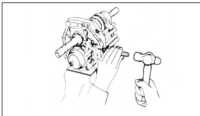
(I) 使用冲头和锤子将弹性圆柱销冲入五倒档换档导块
