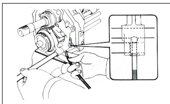
(c) 使用磁棒将锁球装入五倒档换档导块。
